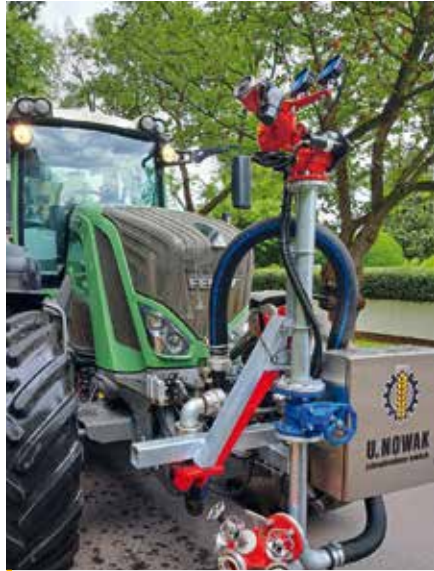
Leistungsfähige Technik: Die Wasserwerfer des Lohnunternehmens können Wasser bis zu 75 m weit ausbringen.
